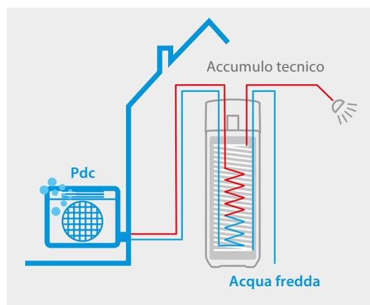
**I plus della tecnologia Daikin:** l'isolamento del serbatoio è realizzato tramite due strati di polipropilene tra i quali è iniettata la schiuma di poliuretano (5,6 cm). Questa tecnologia non necessita di alcuna specifica protezione anticorrosione. In caso di trabocco, l'acqua viene evacuata da una uscita di scarico posta sulla parte superiore del serbatoio. Il polipropilene è anche una garanzia di lunga durata e robustezza (resistenza agli urti).
